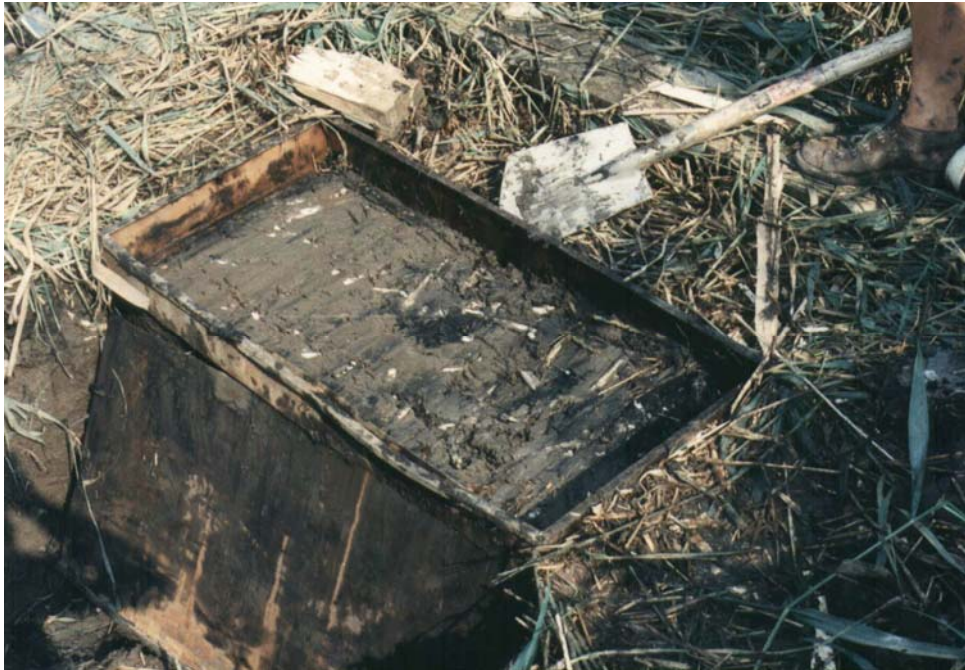
Abbildung 2: Stahlquader mit abgeräumtem obersten Horizont (0-10 cm). Das trennende Stahlfach ist bereits wieder herausgezogen. (Foto: M. Blumberg)
